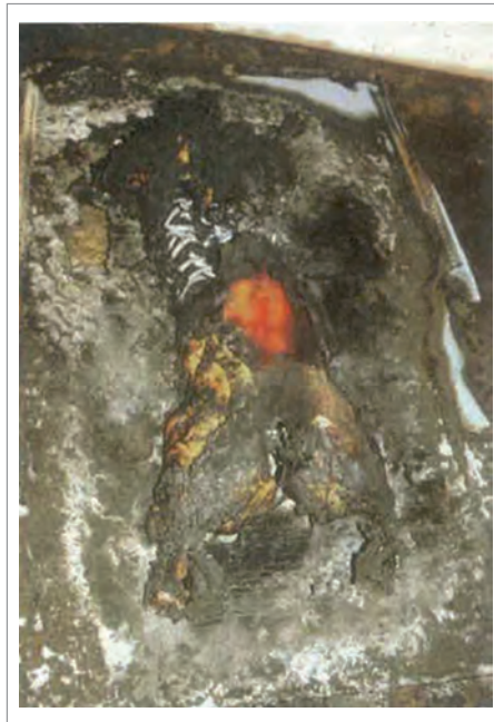
Residuos de la cremación de un cerdo (deHaan y Icove, 2012). Cuando el cuerpo se incinera en función a sus propias grasas deja, después de más de 6 horas de quemado, aproximadamente el 50% de su masa como residuo.
